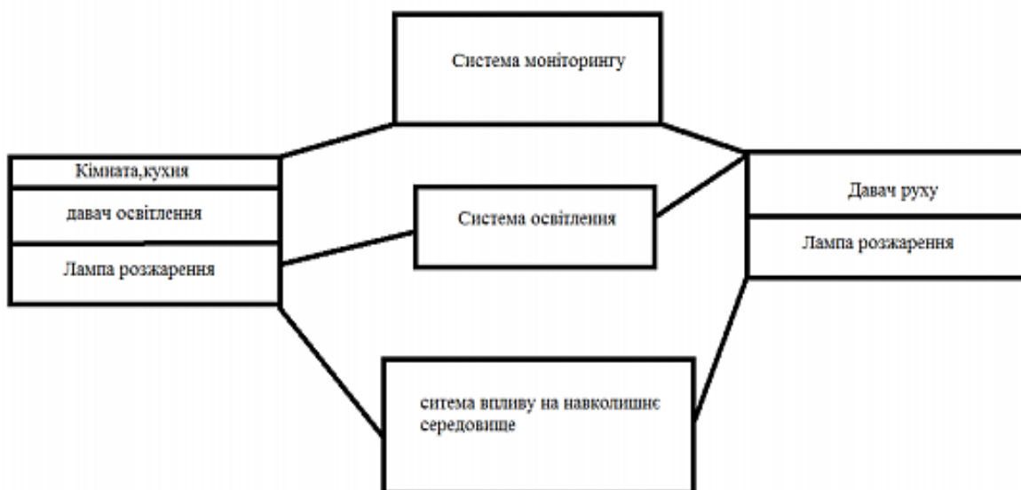
Рисунок 3.4 – Складові підсистеми освітлення
