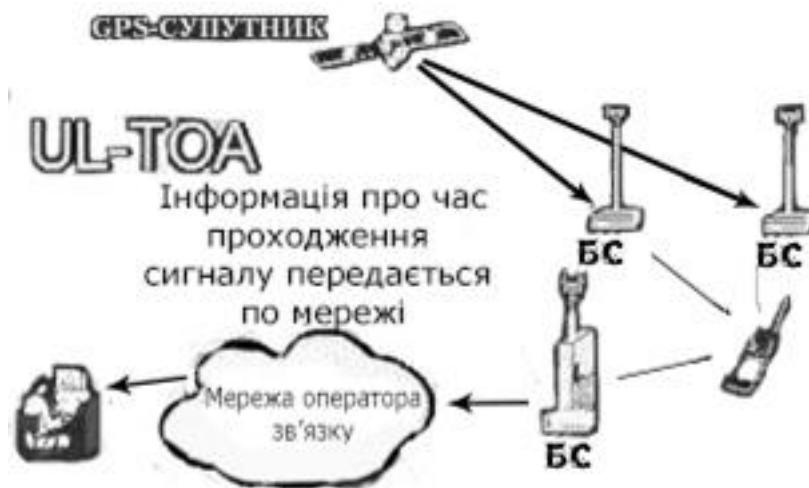
Рис.1.3. - Метод фіксації часу прибуття сигналів
