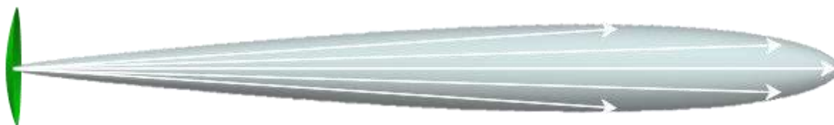
Рисунок 1.2 – Діаграма випромінювання параболоїда
