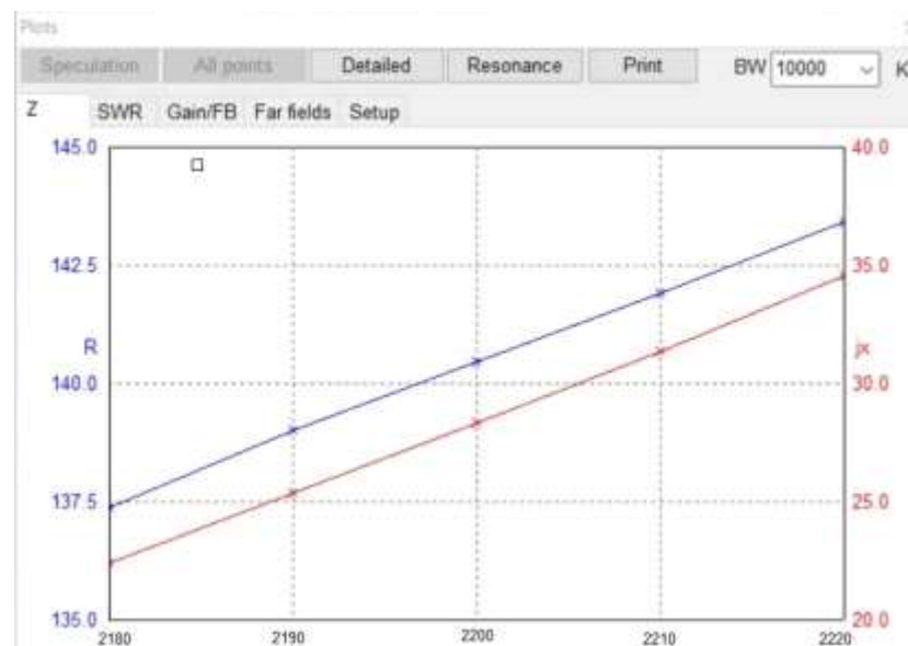
Рисунок. 3.33 – Залежність активного та реактивного опору від частоти
