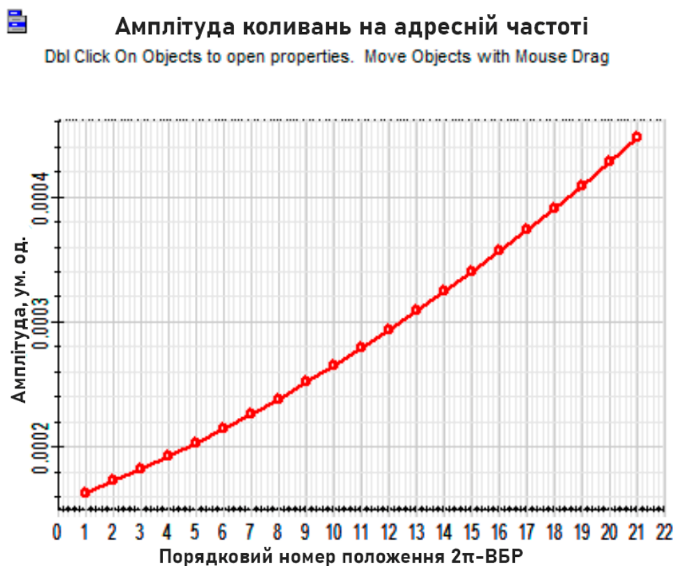
Рисунок 3.13 — Амплітуда коливань на адресній частоті при синхронному зсуві центральної довжини хвилі адресному 2\pi -ВБР структури і вузькосмугового дзеркала в діапазоні від 1549.5 до 1550.50 нм з кроком 0.05 нм.
