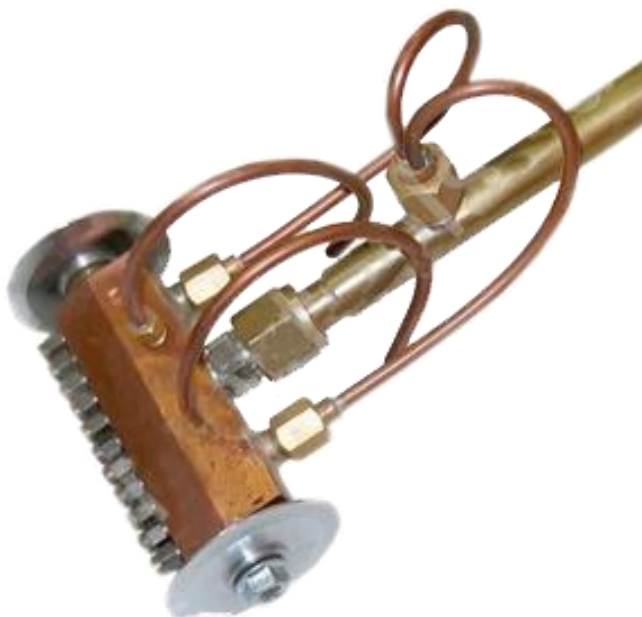
Рис. 2.6. Загальний вигляд термопальника
