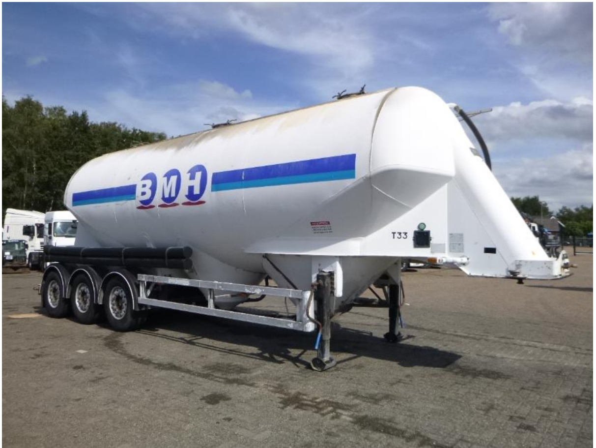
Рисунок.5.1 – Напівпричіп цистерна для сипучих вантажів для транспортування борошна
