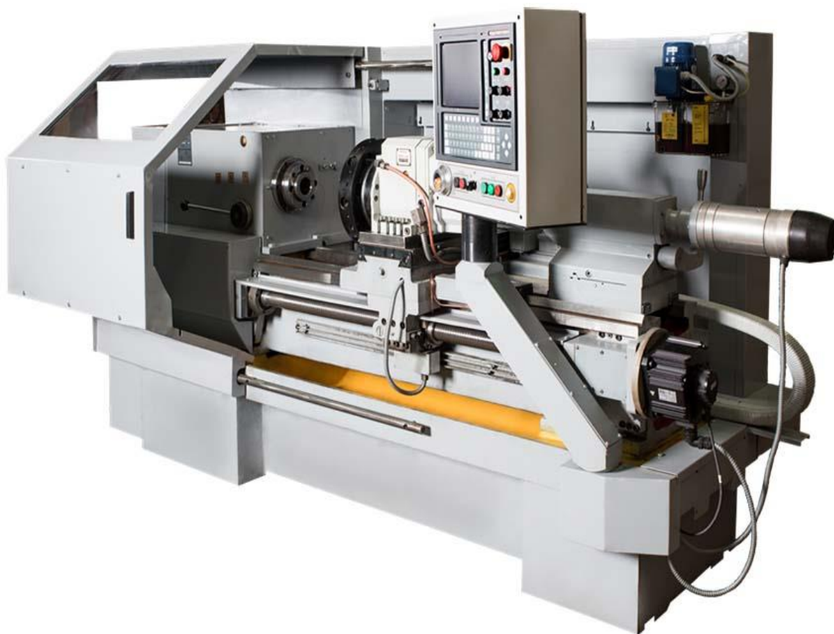
Рис. 2.5. Токарний верстат по металу с ЧПУ 16K20Ф3
