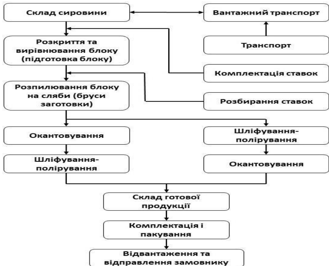
Рис. 2.1. Технологічна схема обробки природного каменю на підприємстві ТОВ «Грантех»
