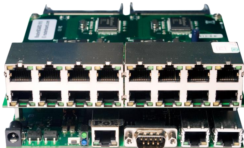
Рис. 1.2. Встановлена MikroTik DaughterBoard RB816 на RB800
