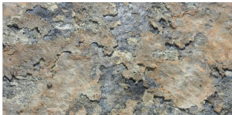
Рис. 1.3. Габро, порушене вивітрюванням
