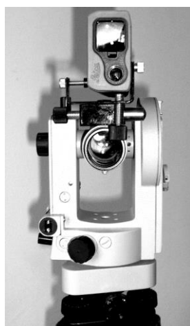
Рис. 4.7 Віддалемір в кріпленні на теодоліт 4Т 30П:
