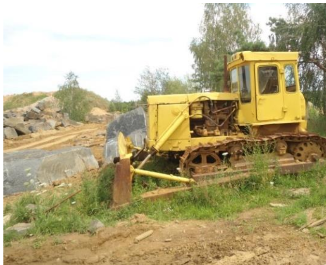
Рис. 2.3. Бульдозер ДЗ-117А на базі трактора Т-130
