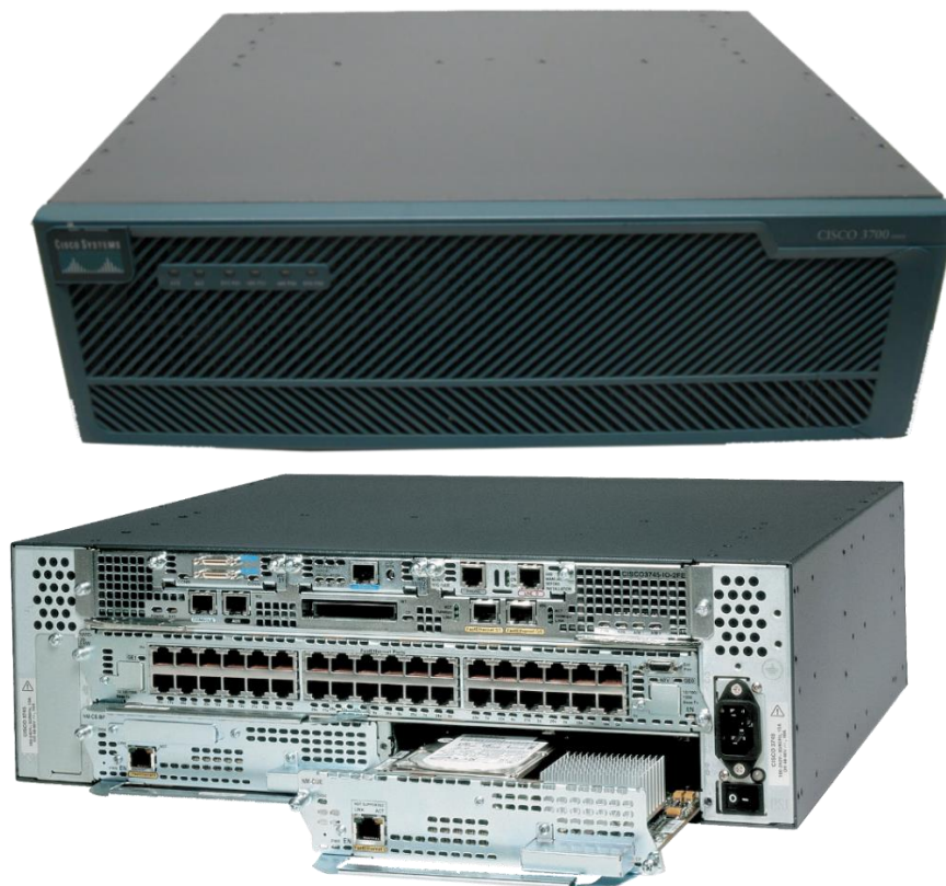
Рис.3.1. – Маршрутизатор Cisco Systems CISCO3745
