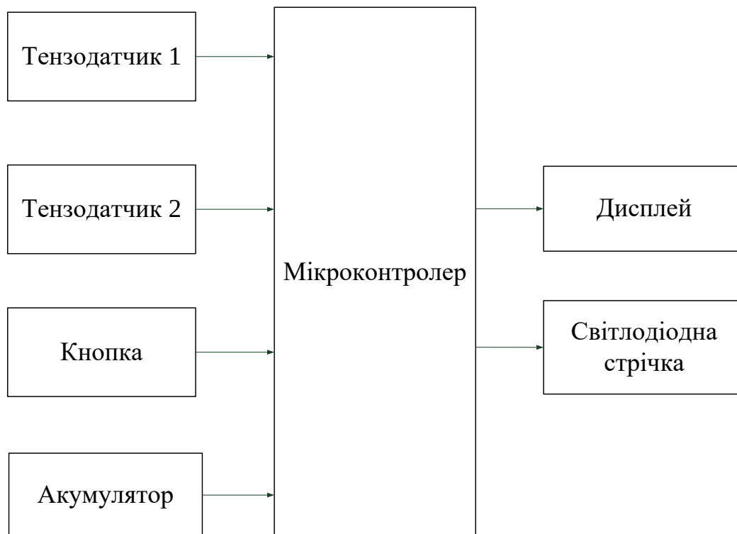
Рис. 3.6 Структурна схема системи вимірювання та контролю ваги
