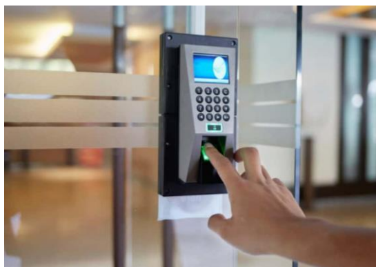
Рис.1.5 Зчитувач відбитку пальця з клавіатурою
