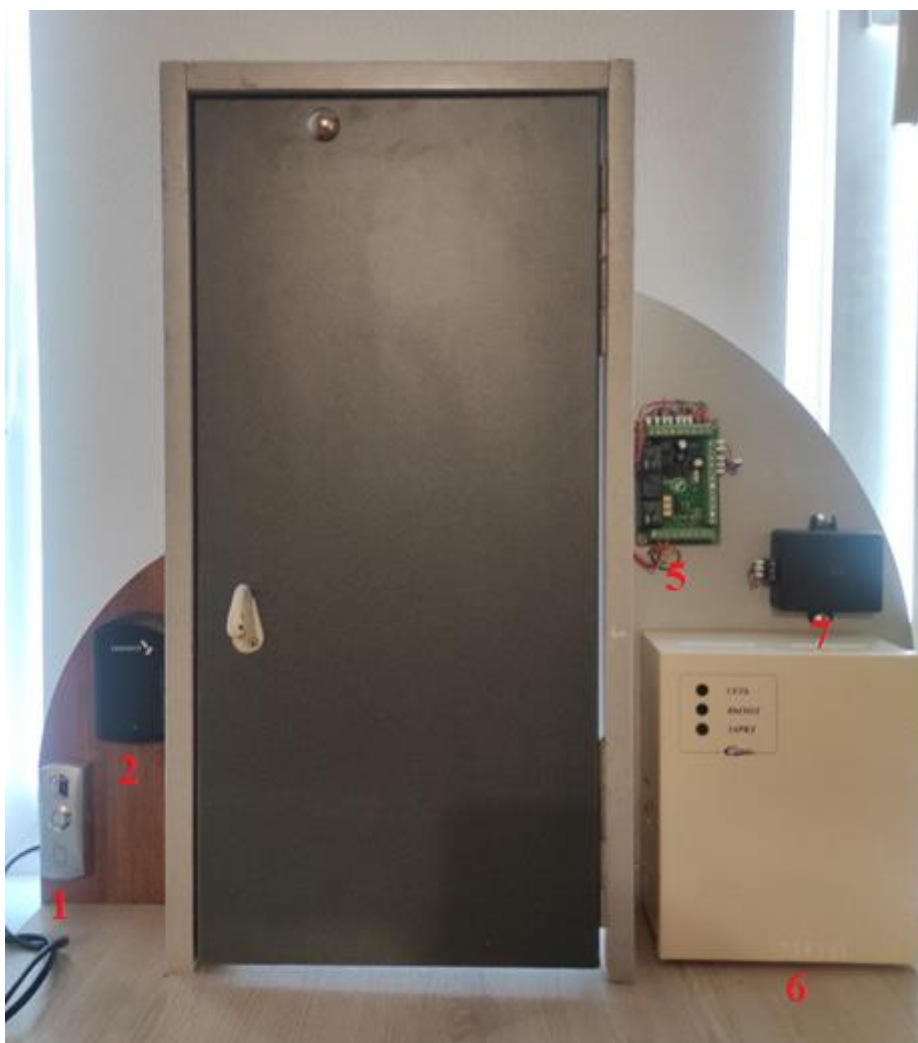
Рис.3.1 - Загальний вигляд розробленого макету стенду комплексу системи контролю і управління доступом
