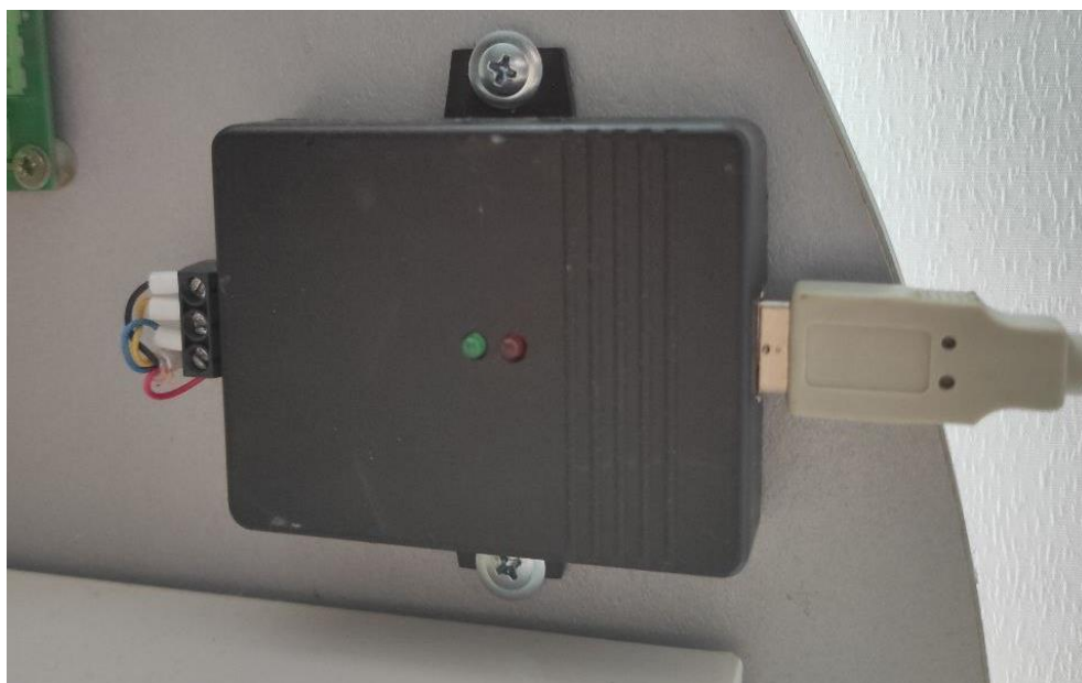
Рис.3.5 Підключення конвертора USB - RS-485
