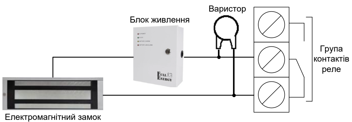
Рис.2.18 Підключення індуктивного навантаження та використання варистора
