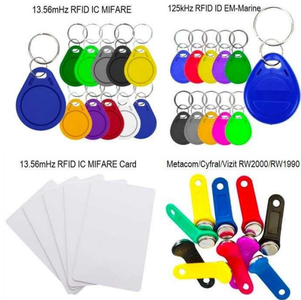
Рис.1.2 Різновиди апаратних ідентифікаторів (RFID-мітки, Proximity-картки та Touch Memory ключі)
