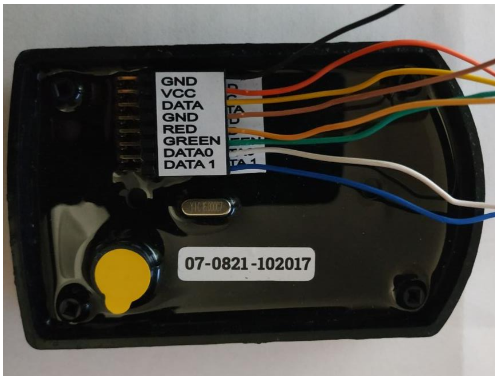
Рис.2.19 Схема роз'ємів зчитувача PR-01
