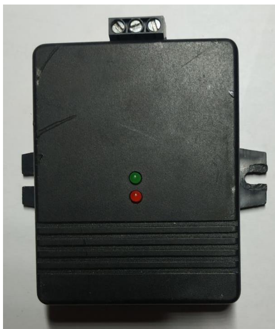
Рис.2.7 Конвертер USB - RS-485
