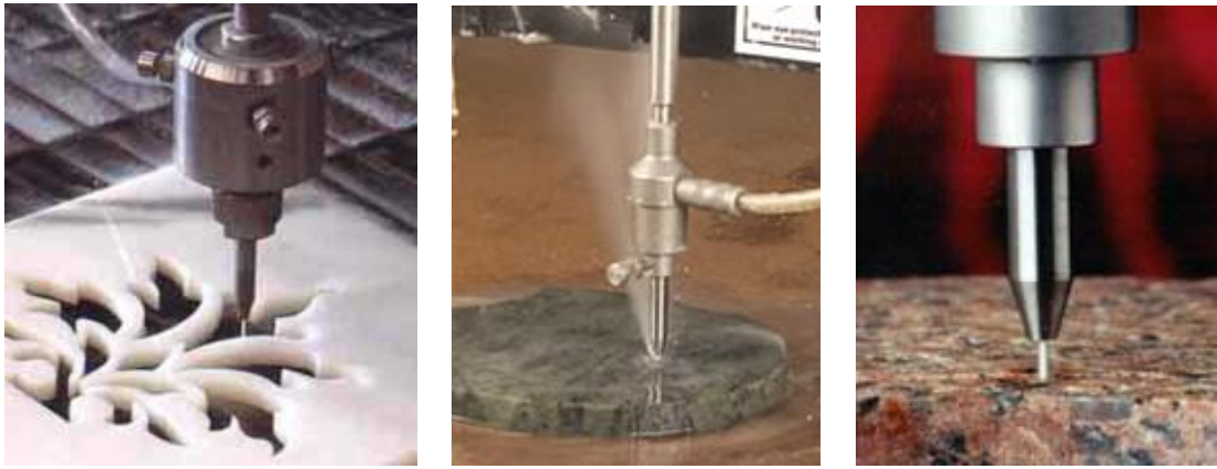
Рис. 2.5. Процес гідроабразивного різання та обробки каменю
