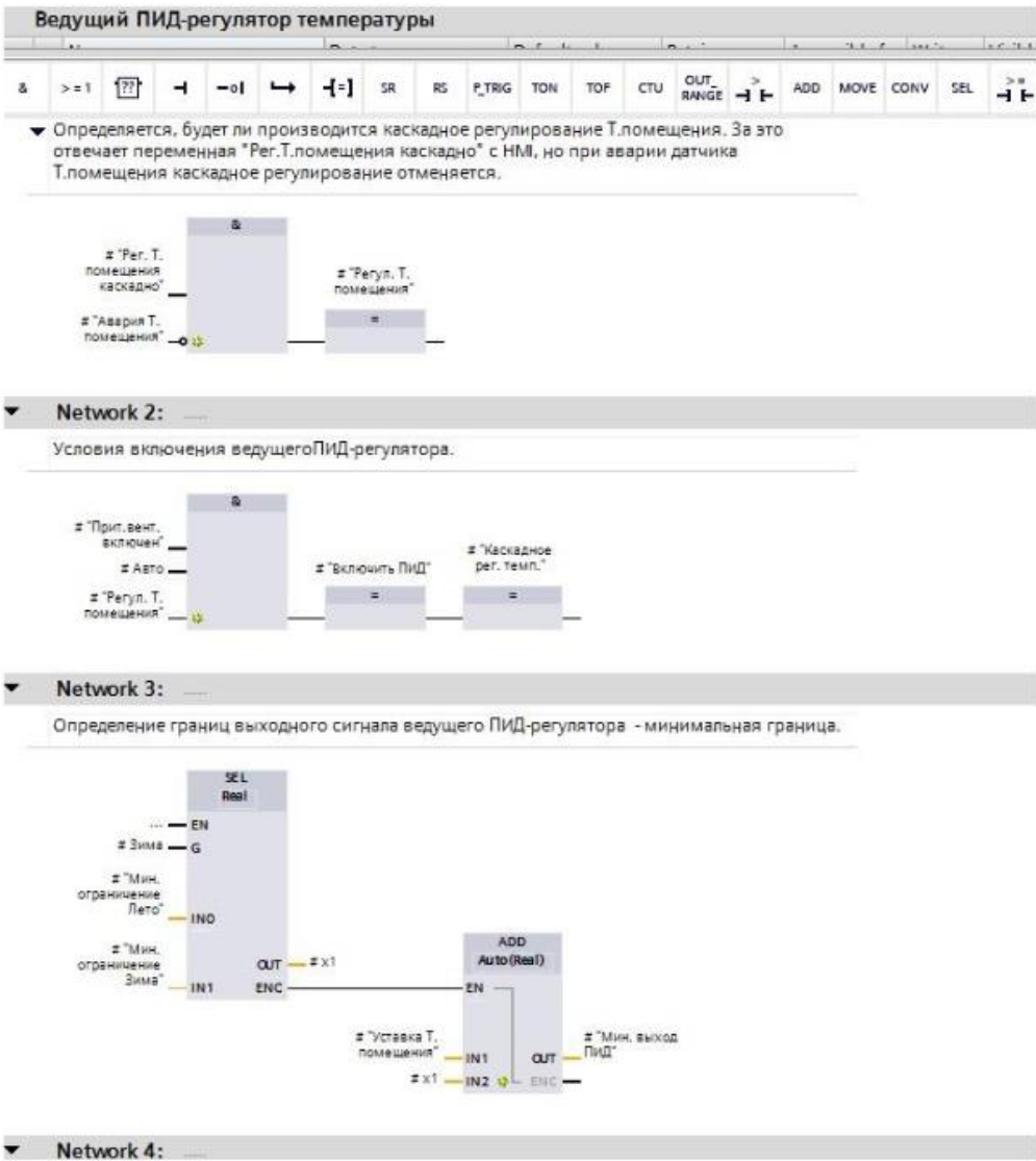
Рисунок 3.7 – Провідний ПІД-регулятор (Network 1-3)
