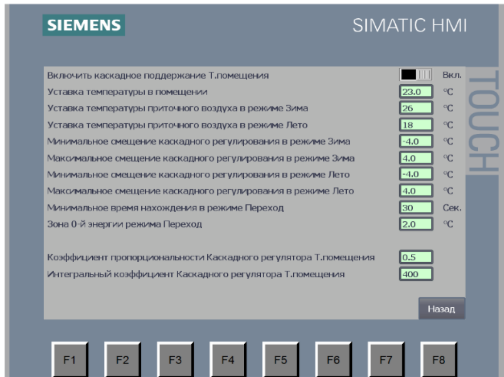
Рисунок 3.11 – Основна форма екрану для налаштування провідного ПД-регулятора
