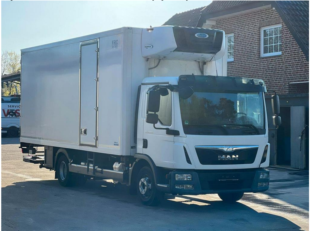
Рис. 1.1. Вантажний автомобіль-рефрижератор MAN TGL 12.220 Розміри (мм):
