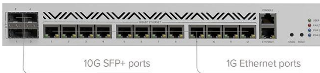
Рисунок 2.4 – Порти MikroTik CCR2116-12G-4S+
