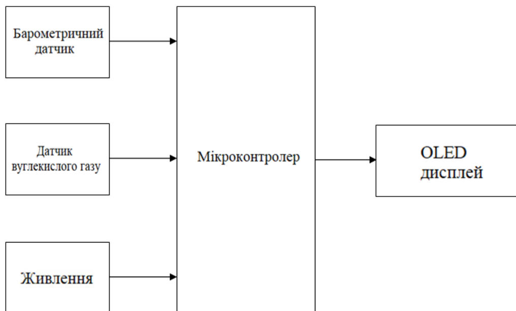
Рисунок 3.6 - Структурна схема вимірювальної системи з OLED дисплеєм
