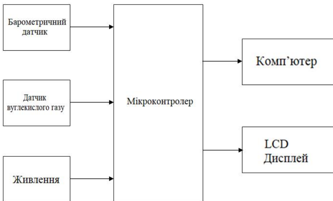
Рисунок 3.5- Структурна схема вимірювальної системи з LCD дисплеєм
