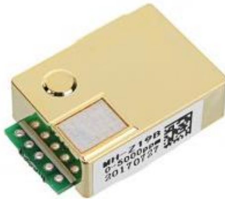
Рисунок 4.6 – Датчик вмісту вуглекислого газу
