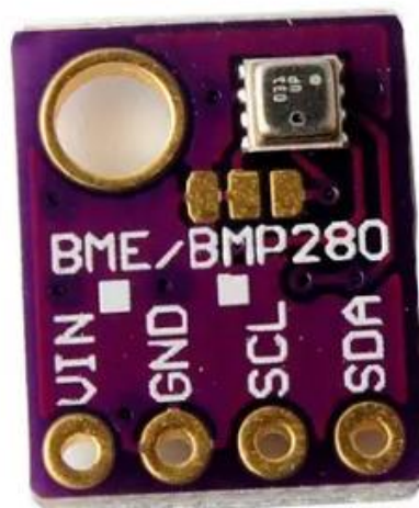
Рисунок 4.5 – Барометричний датчик BME280
