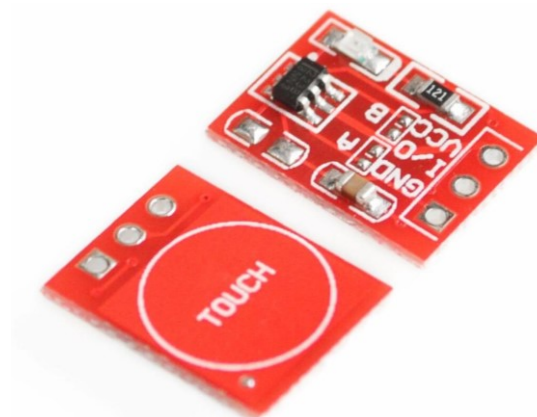
Рис. 4.13 – Сенсорна кнопка ТТР223: зовнішні сторона та зворотна сторона
