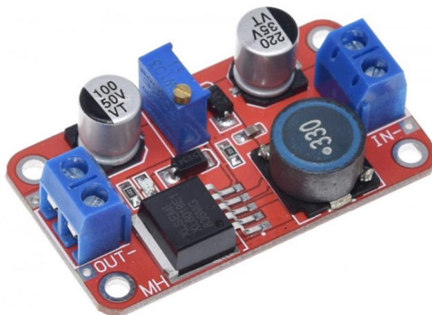
Рис. 4.12 – стабілізатор XL6019 DC-DC 3-40В - 5-45В 5А
