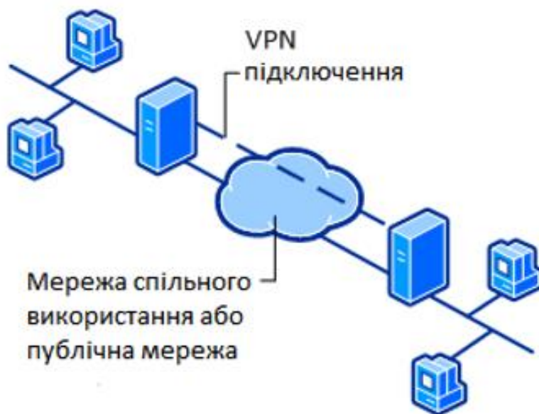
Рисунок 1.2 – Загальна схема роботи VPN
