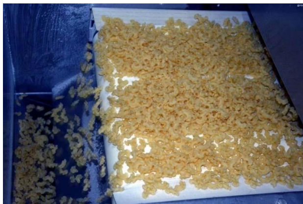
Рисунок 2.7. Транспортування макаронів у сушильну установку
