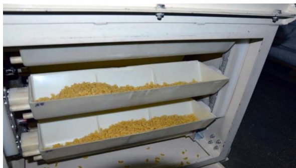
Рисунок 2.8. Транспортування макаронів у бункери
