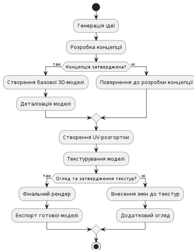
Рисунок 2.2 – Діаграма активності, що описує процес створення комп'ютерної 3D-моделі та текстур
