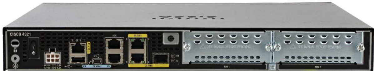
Рисунок 2.4 – Маршрутизатор Cisco ISR4321
