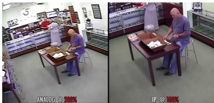
Рисунок 2.8 - Порівняння картинки аналогової та цифрової відеокамери Типові рішення системи відеоспостереження
