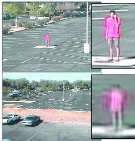
Рисунок 2.5 - Вплив ширини поля зору на ширину, яка необхідна для моніторингу області
