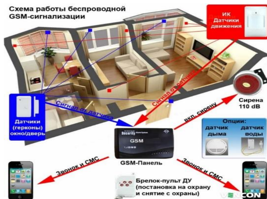
Рисунок 1.2 – Схема роботи GSM-сигналізації
