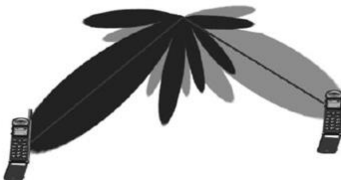
Рисунок 1.1 – ЦАР дозволяє адаптивно перенацілювати промені на мобільних абонентів
