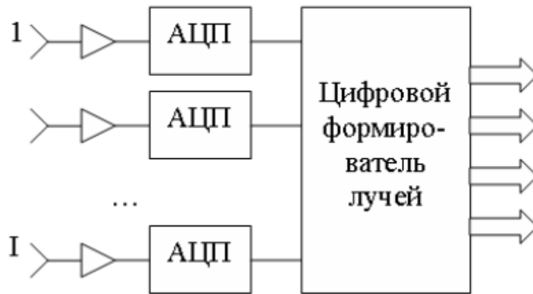
Рисунок 1.3 – Варіант структури приймальної ЦАР
