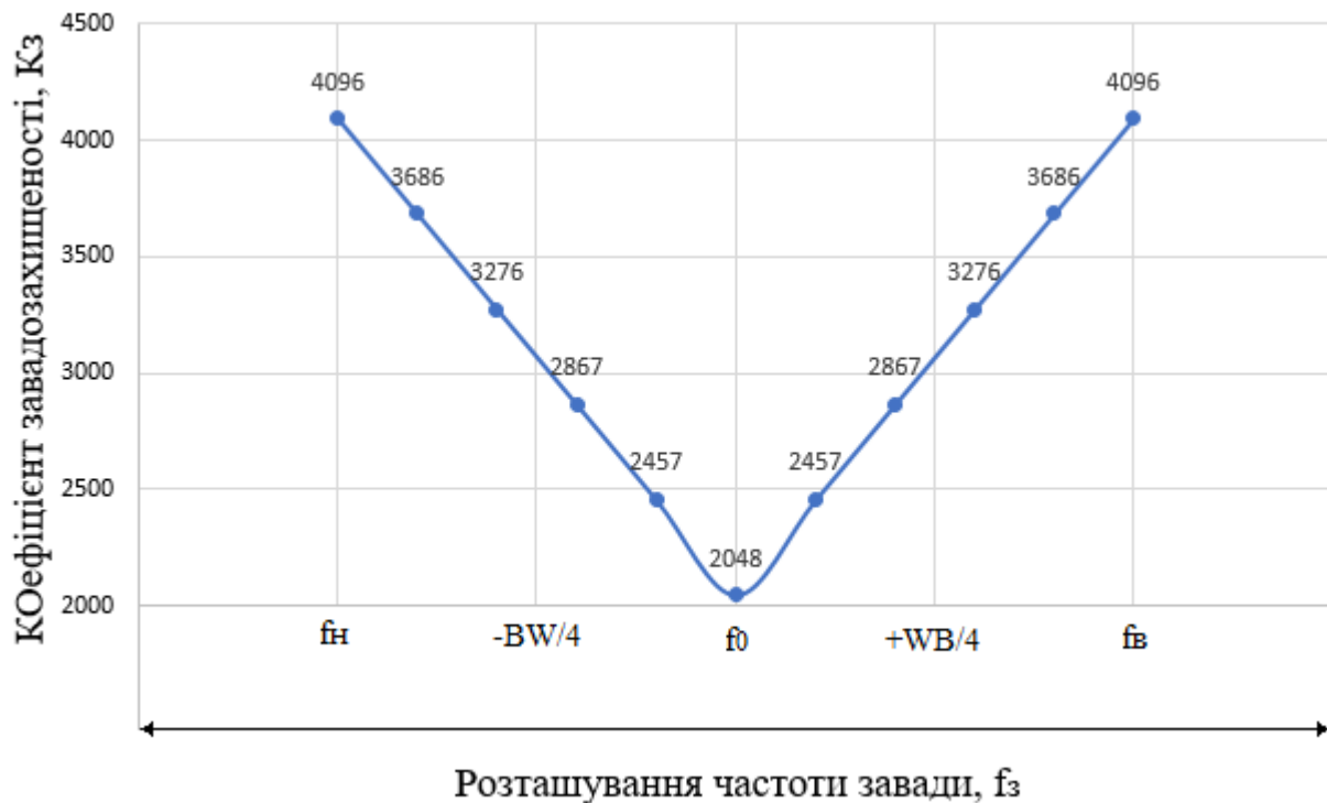
Рисунок 2.25 – Залежність коефіцієнту завадозахищеності K_3 від розташування частоти завади у спектрі сигналу
