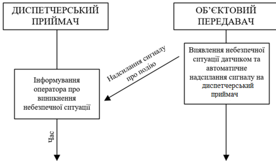
Рисунок 2.6 – Алгоритм роботи системи об'єктового попередження техногенних аварій
