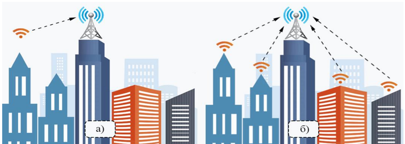
Рисунок 2.1 – Конфігурація системи: а) один передавач; б) декілька передавачів
