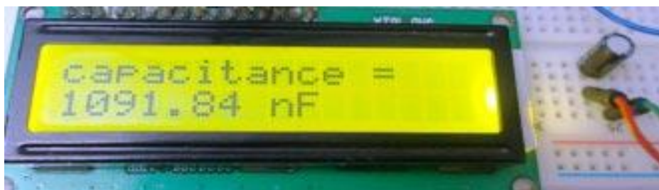
Рисунок 5.1 - Тестування вимірювача ємності на Arduino - електролітичний конденсатор 1 мкФ
