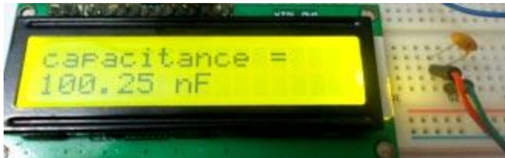
Рисунок 5.3 - Тестування вимірювача ємності на Arduino - керамічний конденсатор 0,1 мкФ
