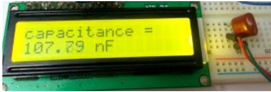
Рисунок 5.2 - Тестування вимірювача ємності на Arduino - поліестеровий конденсатор 0,1 мкФ
