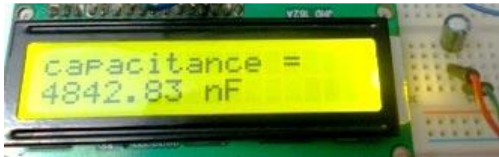
Рисунок 5.4 - Тестування вимірювача ємності на Arduino-електролітичний конденсатор 4,7мкФ
