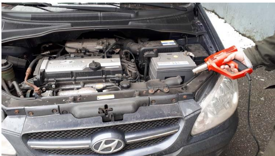
Рис. 2.1. Підігрівання впускного повітря перед повітрязбірником
