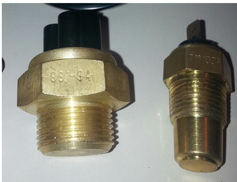
Рис. 4.6. Датчики контролю температури моторного масла
