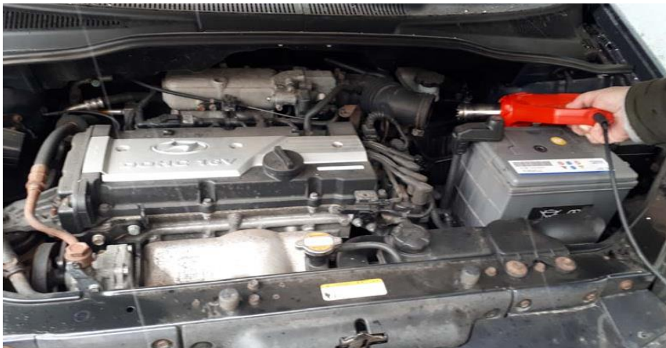
Рис. 2.2. Підігрівання повітря через патрубок перед впускним трубопроводом
