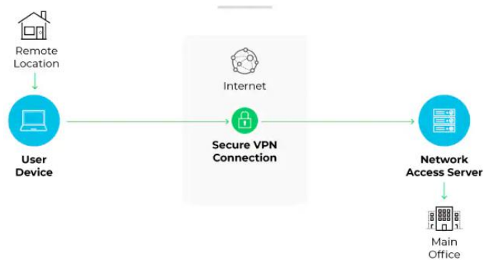
Рисунок 1.11 Схематичне зображення роботи Remote Access VPN
