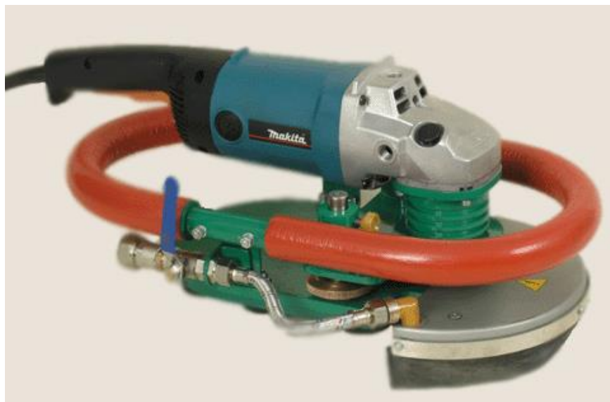
Рис. 2.2. Загальний вигляд кромкошліфувальної машини "Forma-G05"
