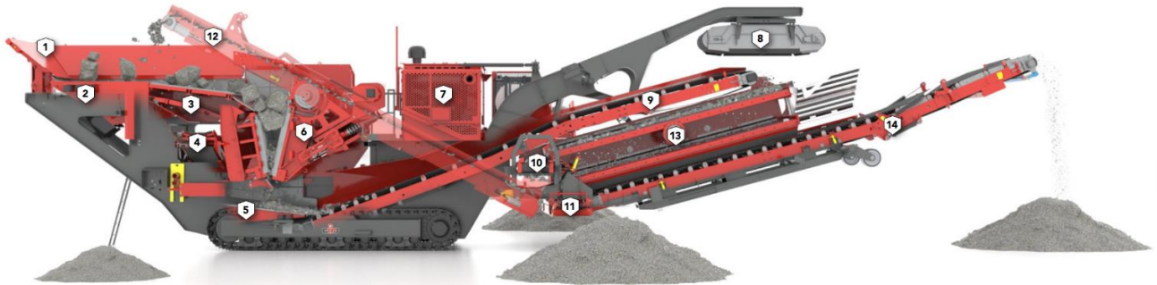
Рис.2.2. Будова МДСК GIPO: 1 – завантажувальний бункер; 2 – завантажувальний блок; 3 – попереднє грохочення; 4 – бічний розвантажувальний конвеєр попереднього грохочення; 5 – розвантажувальний канал (опція); 6 – щокова дробарка; 7 – приводний блок; 8 – магнітний сепаратор; 9 – розвантажувальний конвеєр дробарки; 10 – повернення надгабаритного матеріалу, верхня палуба; 11 – бічне розвантаження, середня/нижня палуба; 12 – зворотний конвеєр; 13 – фінальна сортувальна установка; 14 – конвеєр під ситом.
