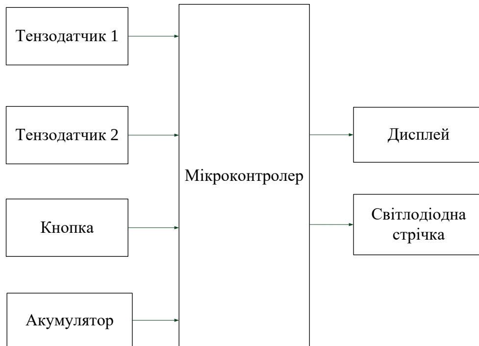
Рис. 3.6 Структурна схема системи вимірювання та контролю ваги
