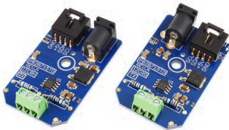
Рис.4.4 – Зображення модуля I2C Long Cable Extender на базі мікросхеми P82B715
