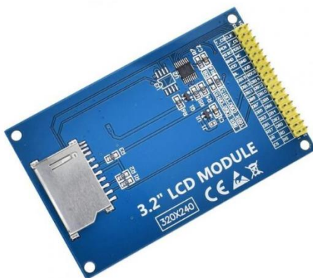
Рис. 4.6. Розташування пінів дисплея на контролері ILI9341
