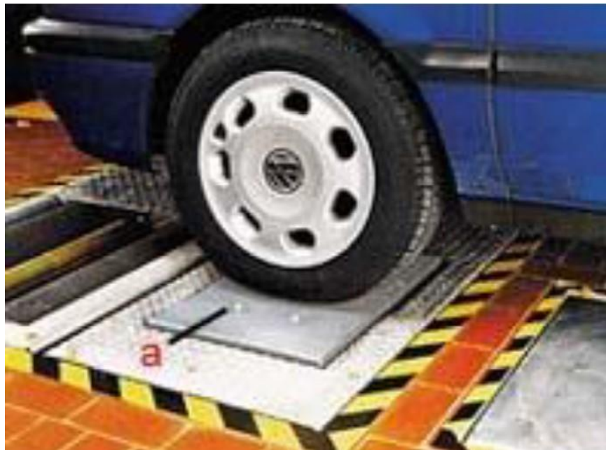
Рисунок 3.12 – Стенд діагностування підвіски методом вимірювання зчеплення (метод EUSAMA)
