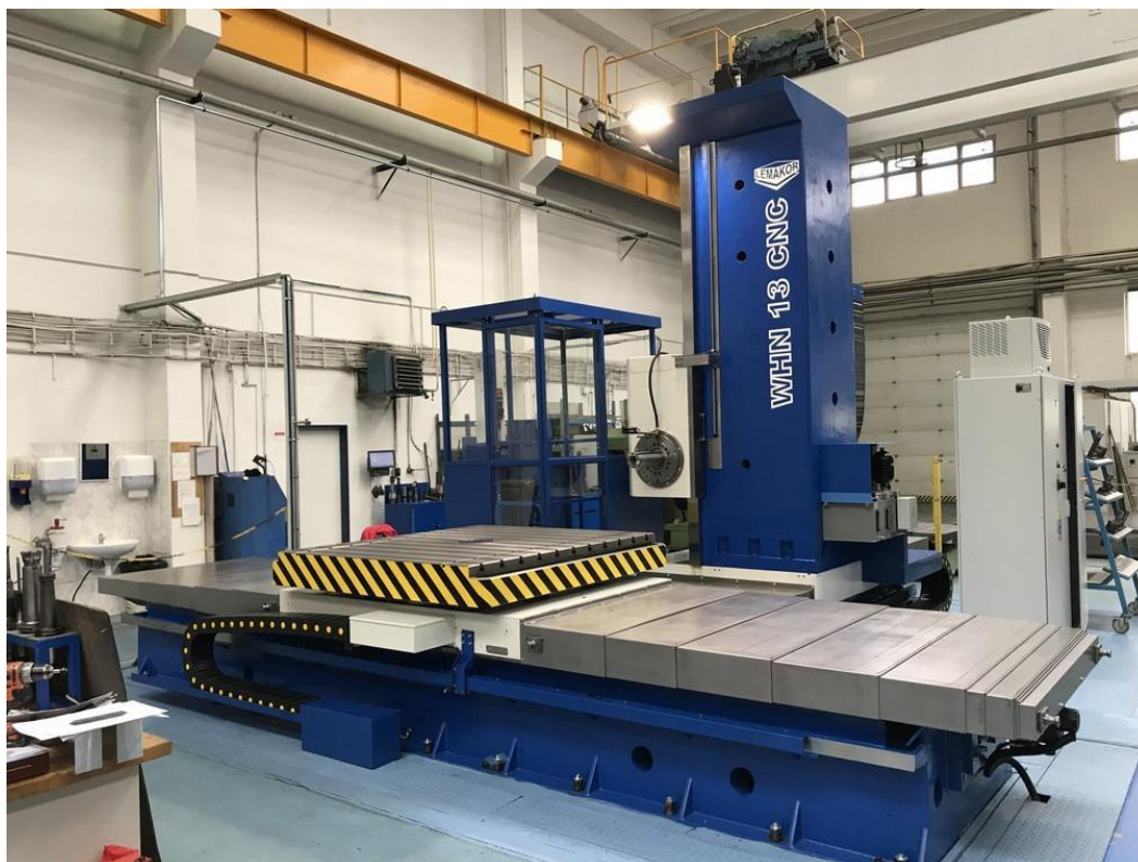
Рис. 2.2. горизонтально-розточувальний верстат з числовим програмним керуванням TOS WHN 13.8 CNC [19]
