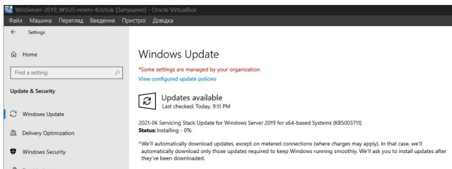
Рис. 4.28 – Встановлення оновлень на резервному WSUS сервері.
