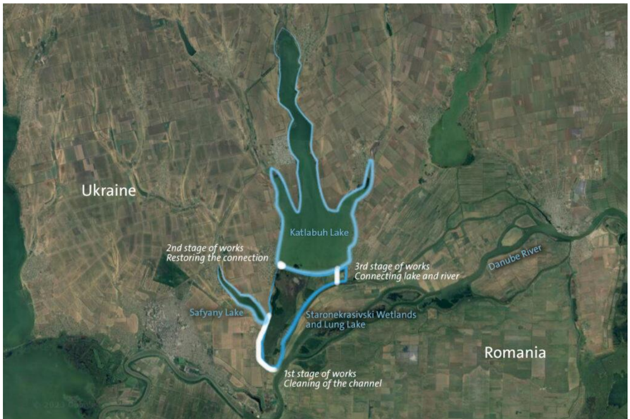
Рис. 4.4 Карта відновлювальних робіт, що проводяться на озерній системі в українській дельті Дунаю [37].
