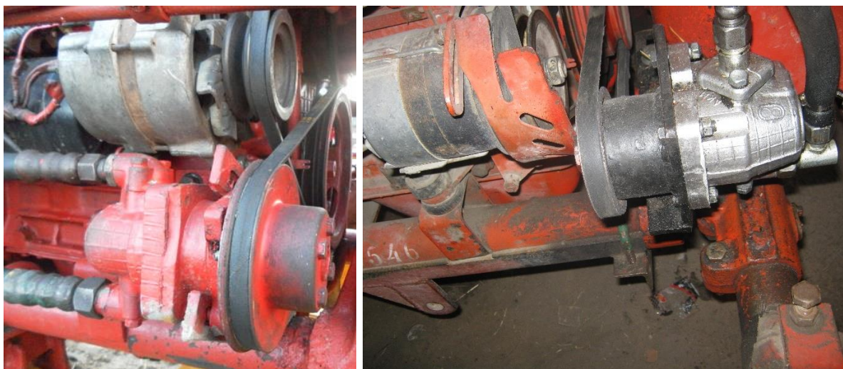
Рисунок 1.3 – Варіанти розміщення маслоснабачення на тракторі [2]
