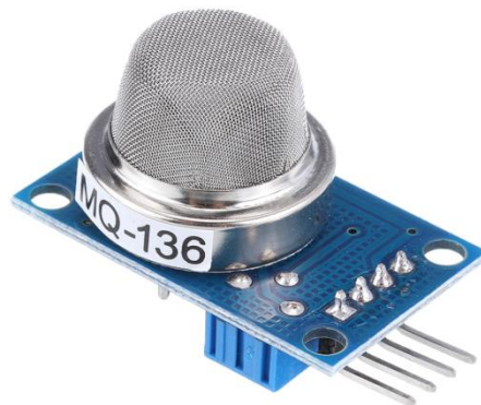
Рис.4.4.Модуль датчика газу сірководню MQ-136
