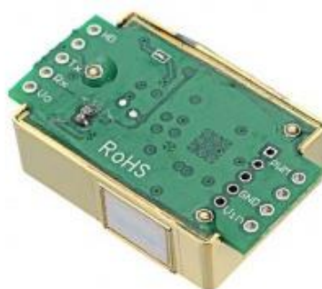
Рис.4.5.Модуль датчика концентрації газів МН-Z19В
