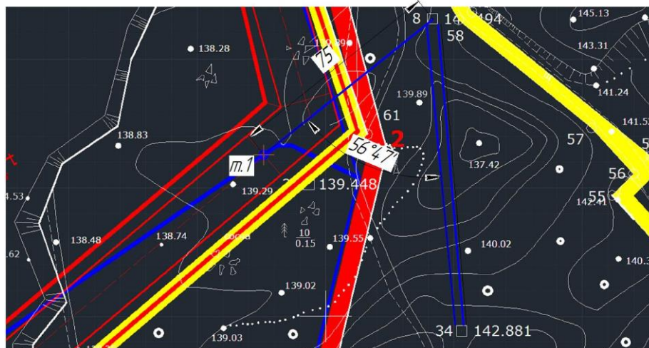
Рис. 4.8. Приклад виносу в натуру елементів осі траншеї
