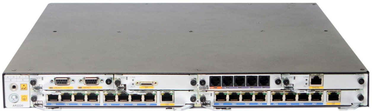
Рисунок 3.1 – Маршрутизатор Huawei AR2220
