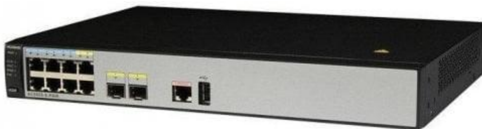
Рисунок 3.4 – Контролер Huawei AC6005
