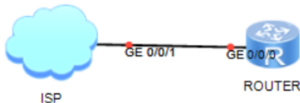
Рисунок 2.5 – Приклад схеми «Один провайдер – Один маршрутизатор»
