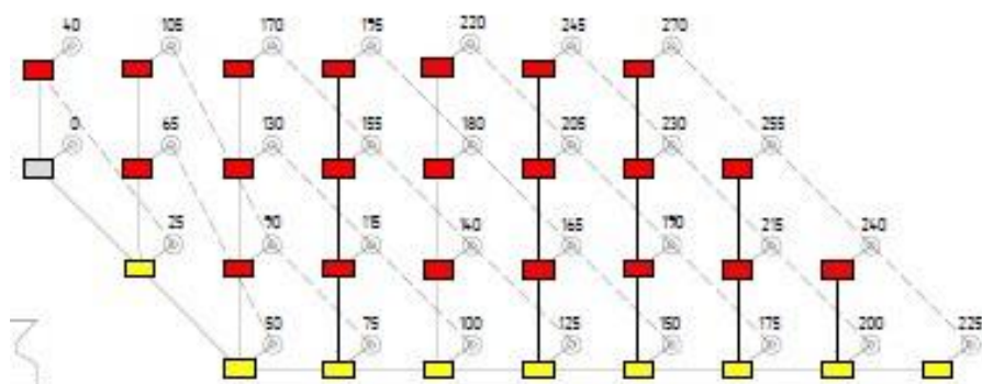
Діагональна схема підривання при шахматній сітці розташування свердловин із застосуванням неелектричної системи ініціювання УНС-ПА-25/8 та УНС-ПА-40/8
