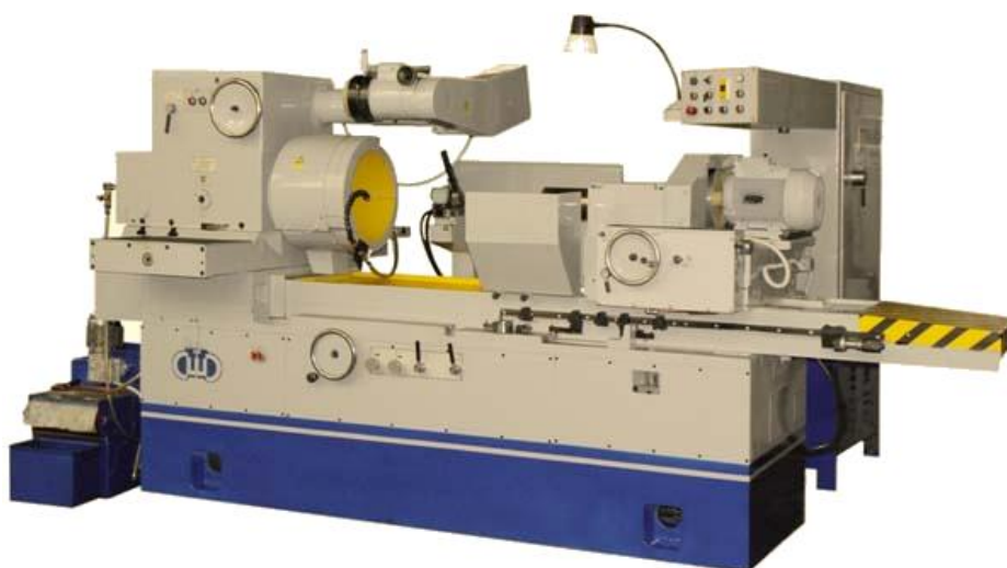
Рис. 8. Внутрішньошліфувальний верстат 3K228В [19]
