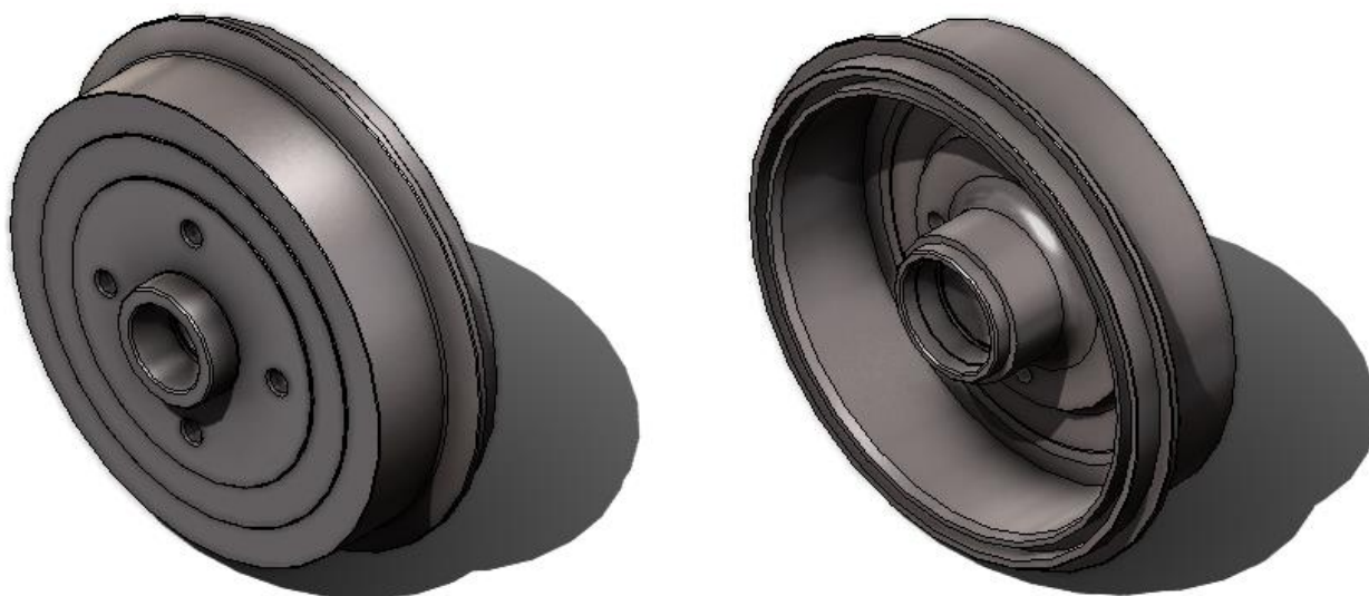
Рис. 5. 3D модель деталі «Гальмівний барабан» автомобіля Daewoo Lanos
