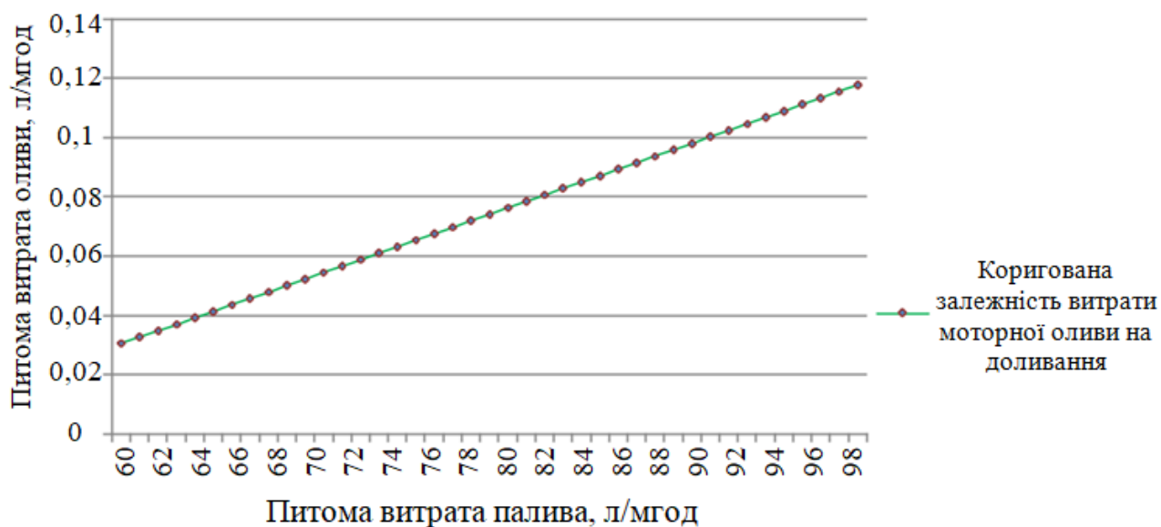
Рис. 3.4. - Витрата оливи двигуном CAT 3512 з інтервалом напрацювання 5000-15000 мгод
