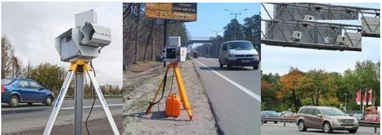
Рисунок 1.7 – Радар "Арена" радіочастотного виміру швидкості
