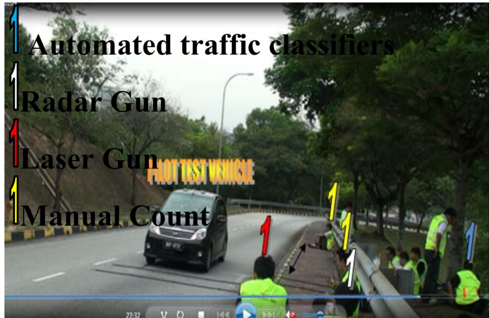
Рисунок 3.8 – Зона дослідження та розташування приладів вимірювання швидкості
