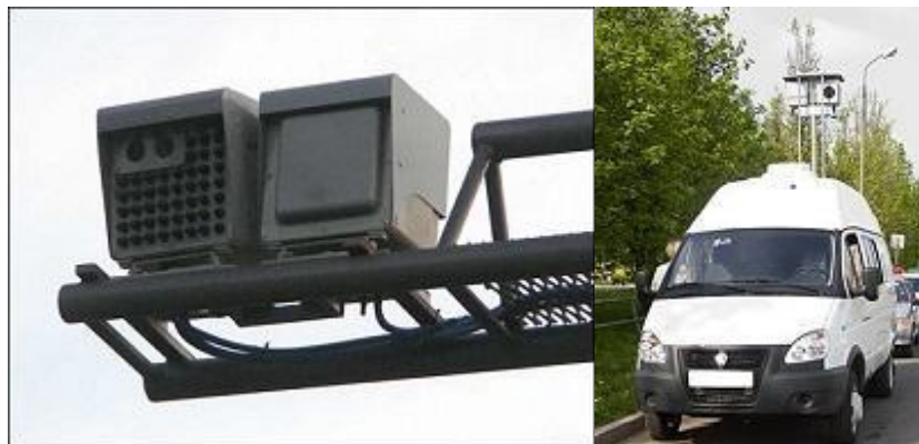
Рисунок 1.5 – "Стріла СТ" (стаціонарний) та "Стріла М" (мобільний)
