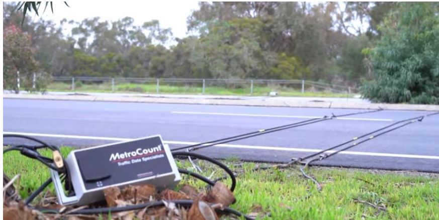
Рисунок 3.3 – Дорожні датчики, встановлені на дорозі
