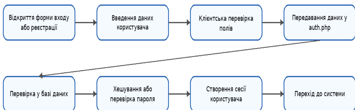
Рис. 2.3. Алгоритм реєстрації та авторизації користувача
