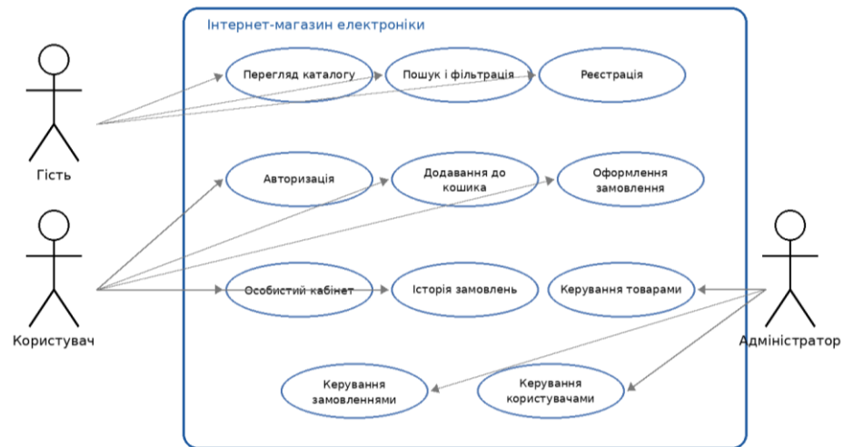
Рис. 2.1 – Діаграма варіантів використання системи ElectroShop
