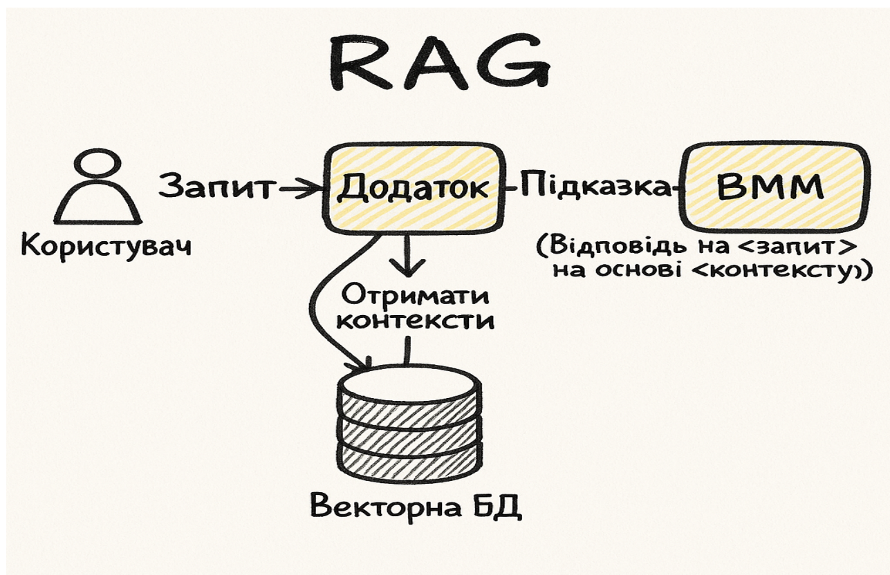
Рисунок 1.5 – Схема роботи методу Retrieval-Augmented Generation.
