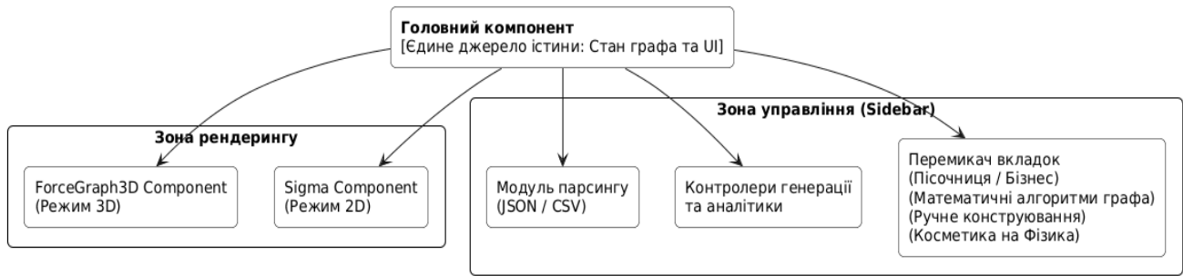
Рис. 2.5. Структурна схема ієрархії компонентів вебзастосунку
